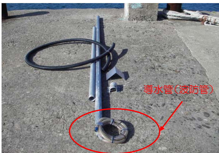
潮位計センサー保護管 保護管取付金具
