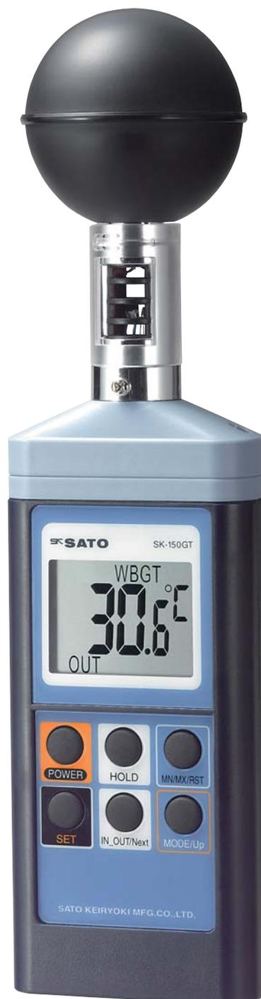
※WBGT指数 : Wet Bulb Globe Temperature(湿球黒球温度)の略で、ISO 7243/JIS Z8504で規定されている作業者の熱ストレス(暑熱環境)の評価に使用される指数です。湿球温度、黒球温度(輻射熱)、乾球温度から算出される体感温度のひとつです。
