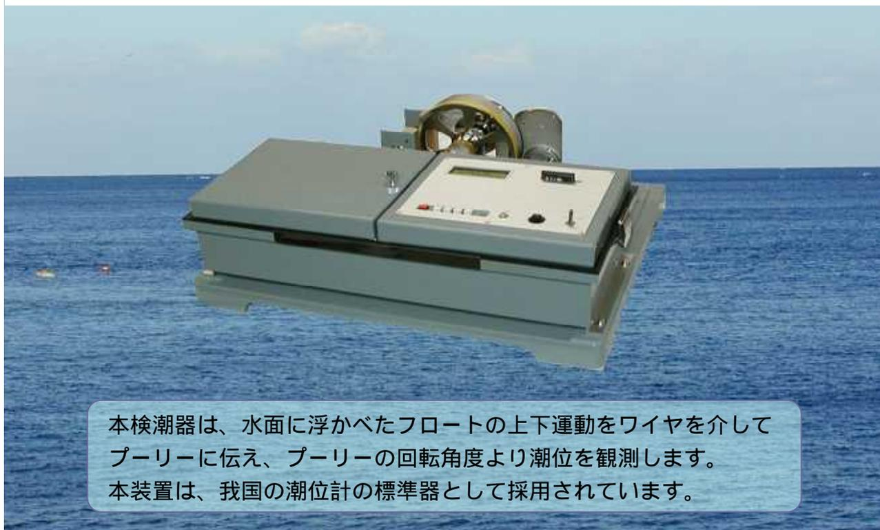
本検潮器は、水面に浮かべたフロートの上下運動をワイヤを介してプーリーに伝え、プーリーの回転角度より潮位を観測します。
